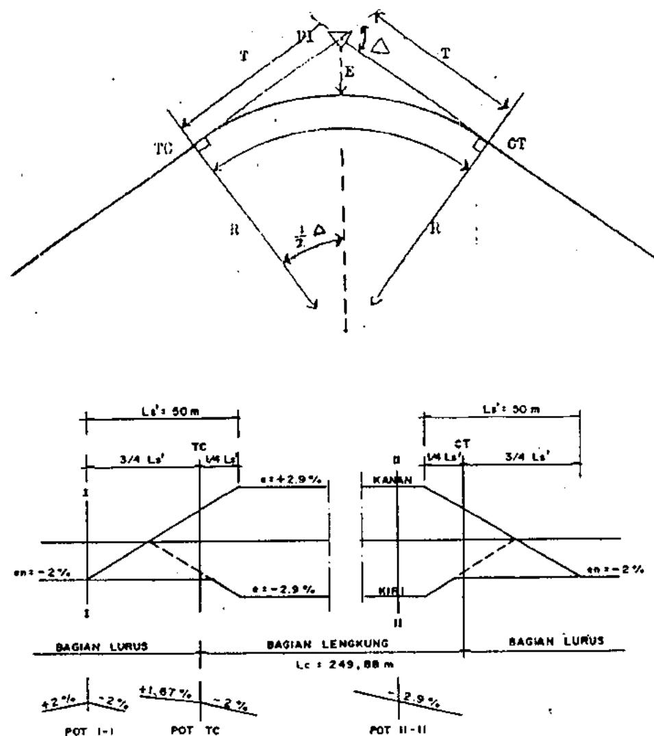
Gambar 3.8. Diagram Superelevasi Pada Lengkung Busur Lingkaran Sederhana dengan sumbu jalan sebagai sumbu putar
