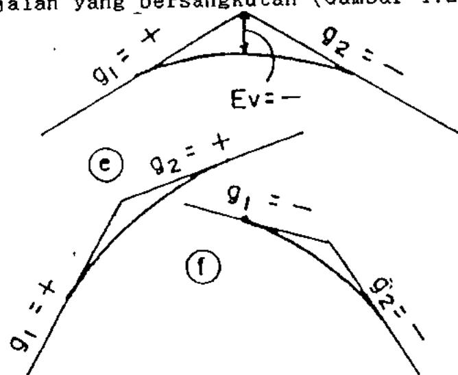
Gambar 4.2. Jenis lengkung vertikal cembung dilihat dari titik perpotongan kedua tangen
