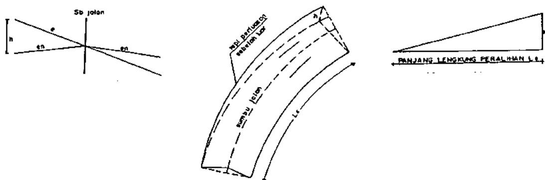
Gambar 3.1. Panjang lengkung peralihan menurut Bina Marga
