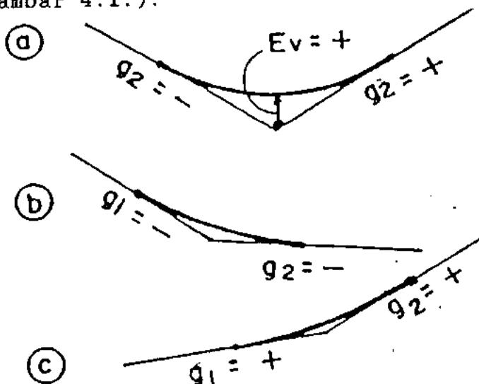
Gambar 4.1. Jenis lengkung vertikal cekung dilihat dari titik perpotongan kedua tangen
