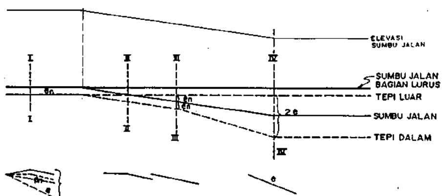
Gambar 3.7. Diagram superelevasi dengan tepi luar perkerasan sebagai sumbu putar pada jalan tanpa median
