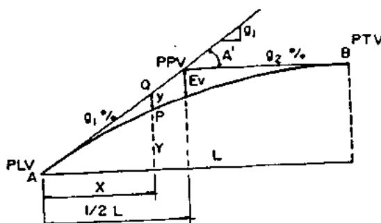
Gambar 4.3. Lengkung Vertikal parabola
