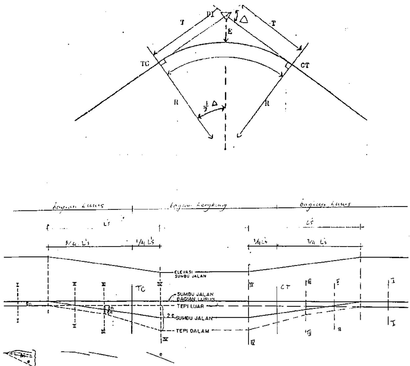
Gambar 3.14. Diagram Superelevasi Pada Lengkung Busur Lingkaran Sederhana dengan tepi luar sebagai sumbu putar
