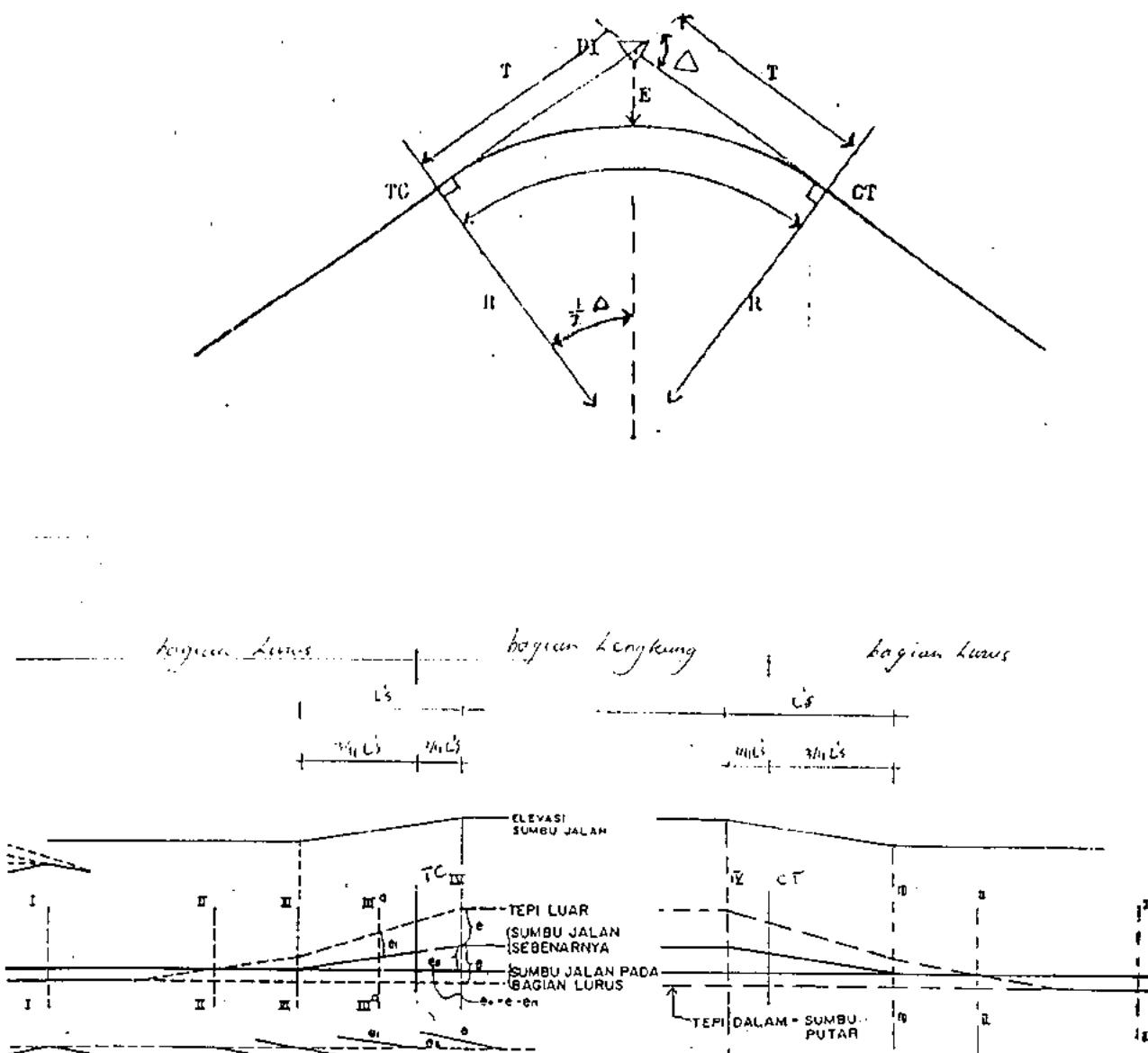
Gambar 3.11. Diagram Superelevasi Pada Lengkung Busur Lingkaran Sederhana dengan tepi dalam sebagai sumbu putar
