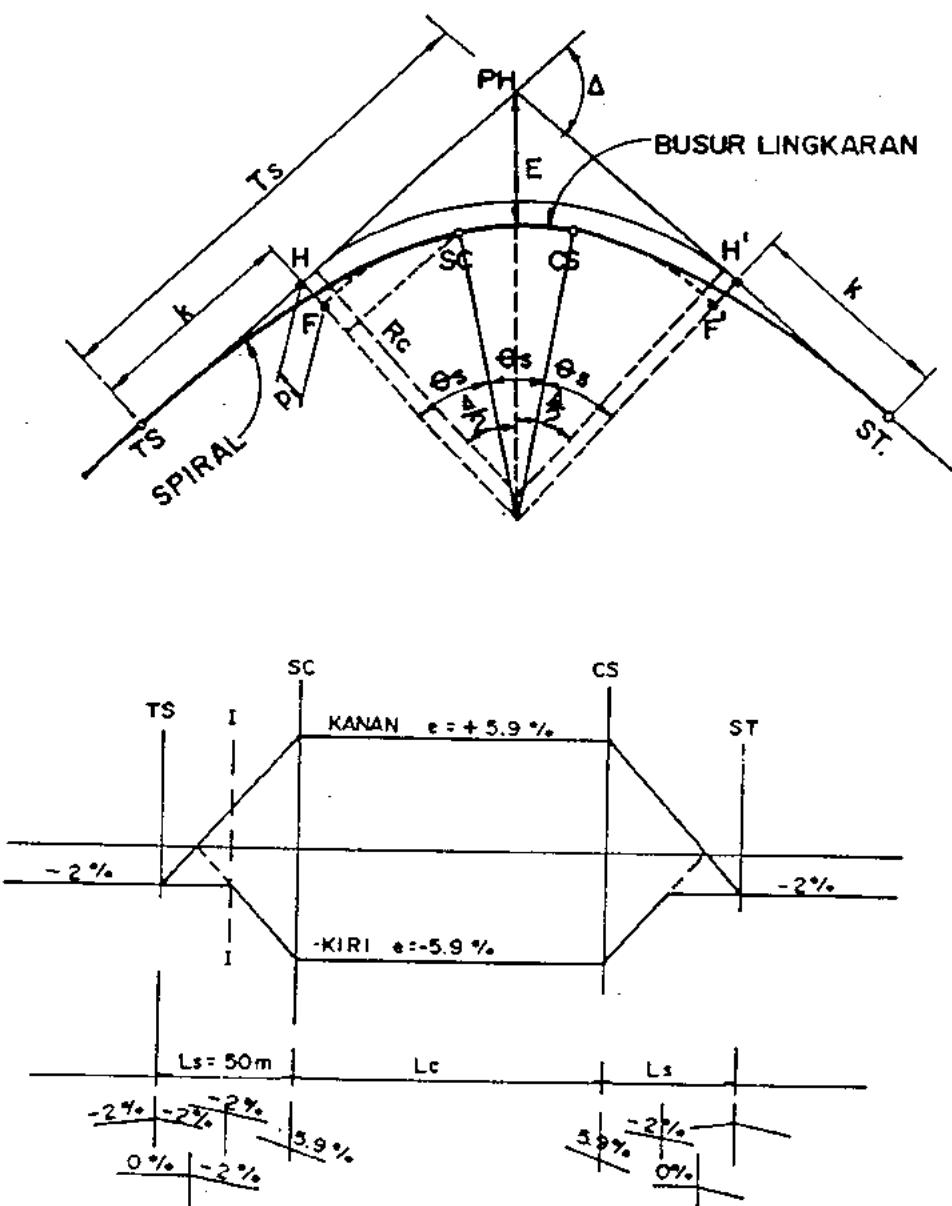
Gambar 3.9. Diagram Superelevasi Pada Lengkung Spiral-Lingkaran-Spiral dengan sumbu jalan sebagai sumbu putar
