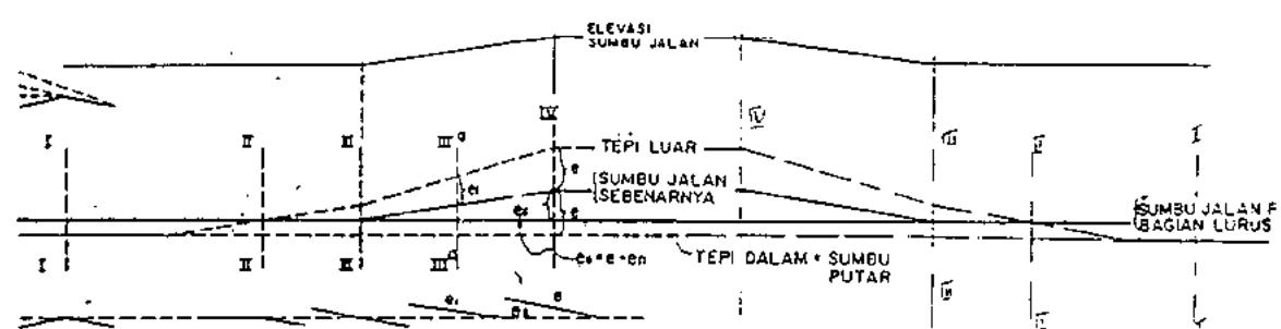
Gambar 3.12. Diagram Superelevasi Pada Lengkung Spiral-Lingkaran-Spiral dengan tepi dalam sebagai sumbu putar
