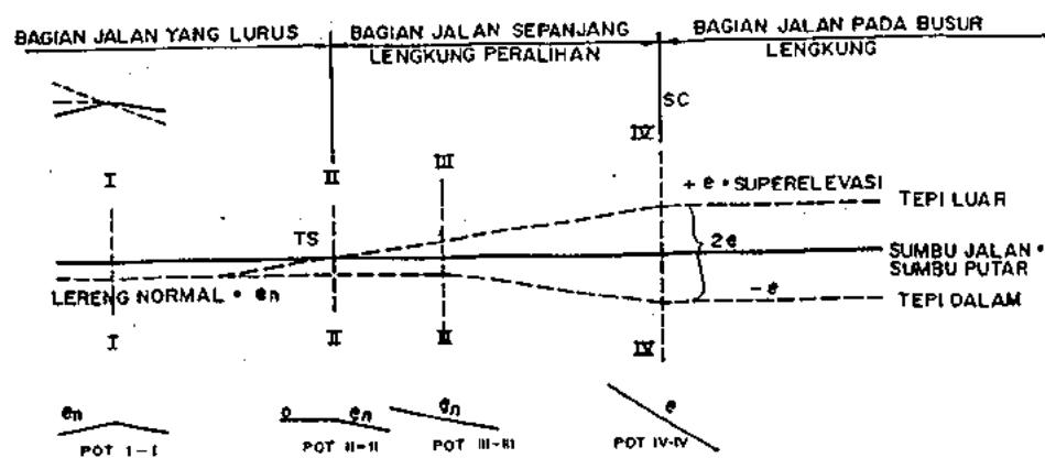
Gambar 3.5. Diagram superelevasi dengan sumbu jalan sebagai sumbu putar
