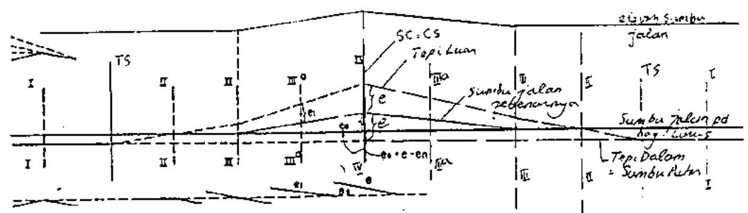
Gambar 3.13. Diagram Superelevasi Pada Lengkung
