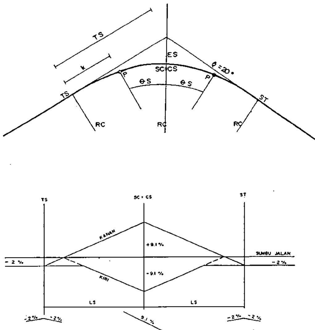
Gambar 3.10. Diagram Superelevasi Pada Lengkung Spiral-Spiral dengan sumbu jalan sebagai sumbu putar
