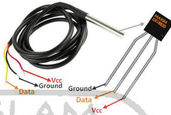
Gambar 2-16 Konfigurasi Kaki Sensor DS18B20
