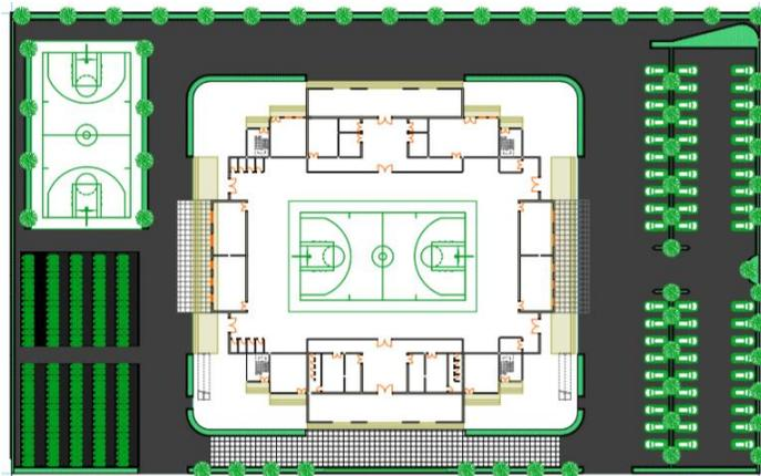
Evaluasi yang menjadi kekurangan dalam gambar site plan ini yakni perubahan dalam perkerasan untuk lantai pemanasan pemain di berikan ketinggian yang berbeda , dan ara ini tidak dapat di lewati kendaraan berupa motor maupun mobil.
