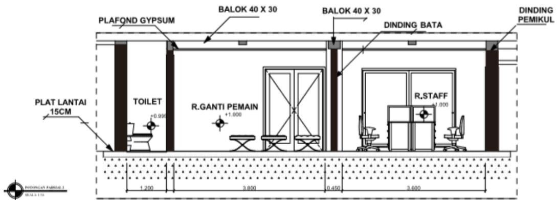
Evaluasi yang menjadi kekurangan dalam gambar Potongan Parsial ini yakni keterangan dalam gambar yang kurang jelas dalam dinding yang di potong ,di blok hitam di karenakan dinding yang terpotong adalah dinding pemikul.
