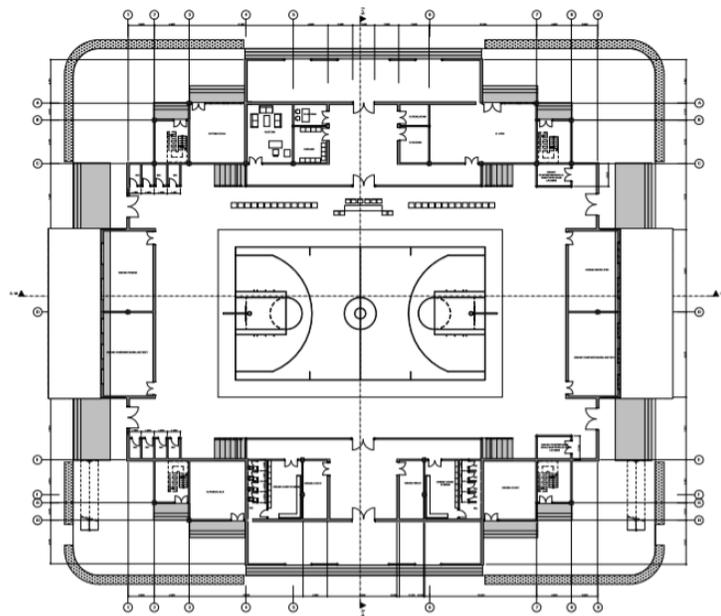
Evaluasi yang menjadi kekurangan dalam gambar Denah lantai 1 ini yakni perubahan di bagian Dinding pemikul di bagian timur dan barat di karenakan dinding tidak sesuai dengan peraturan peraturan untuk pemasangan dinding pemikul , dan perubahan di bagian ruang ganti pemain yaitu penambahan untuk dinding wc dan peletakan loker room bagi para pemain dan pelatih .
