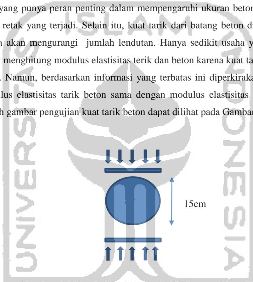
**Gambar 3.2 Benda Uji silinder di Uji Dengan Kuat Tarik**
