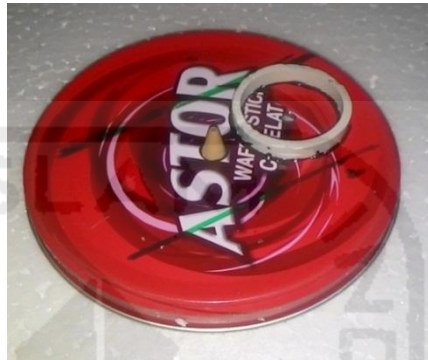
Gambar 4.2 Silinder tenaga dan penahan poros piston displacer
