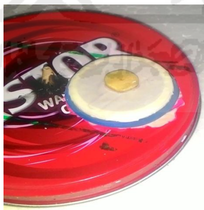
Gambar 4.3 Diafragma yang ada pada silinder panas
