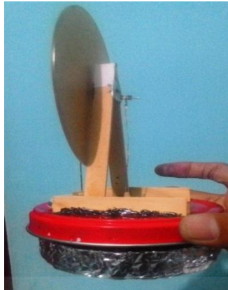
Gambar 4.8 Piston displacer dan piston tenaga terhubung ke engkol poros flywheel
