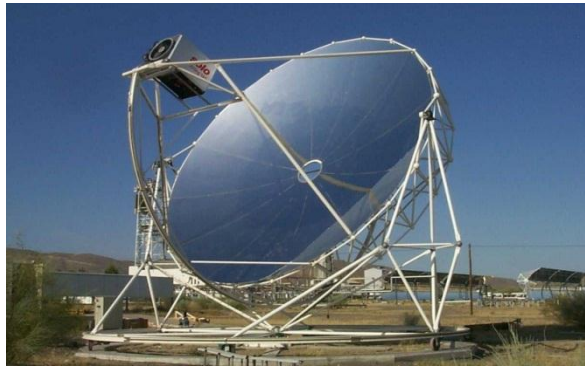
Gambar 2. 2 Mesin Stirling Menggunakan Parabolic Mirror Dish
