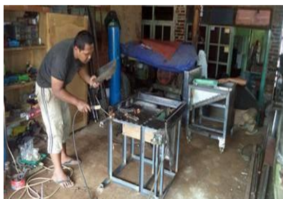
Gambar 3. Proses perakitan rangka
