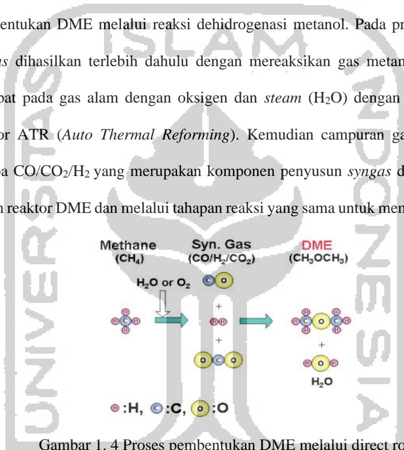
Gambar 1. 4 Proses pembentukan DME melalui direct route
