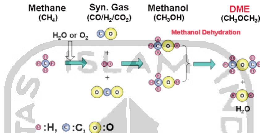
Gambar 1. 3 Proses pembentukan DME melalui indirect route
