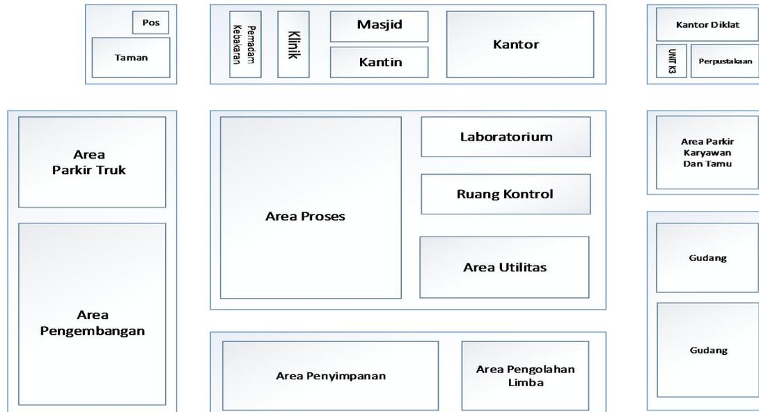
Gambar 4.2. Lay Out Pabrik Skala 1 : 2000
