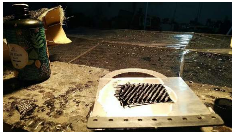
Gambar 4. 6 Proses Curing dengan Lampu Tembak Cat Oven
