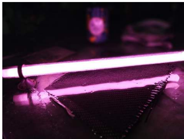
Gambar 4. 4 Proses Curing Dengan Lampu UV Aquarium
