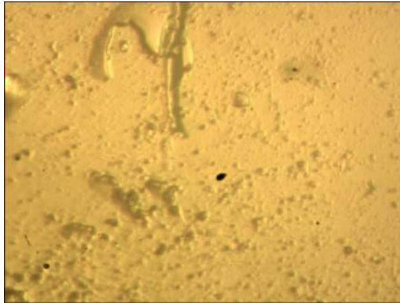
Gambar 4. 14 Spesimen 1 Layer Foto mikro perbesaran 40 kali
