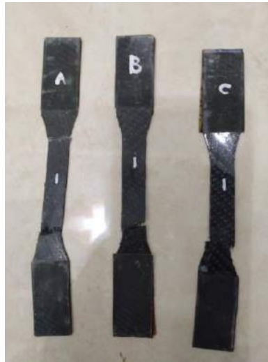
Gambar 4. 21 Hasil Uji 1 Layer Setelah Pengujian Tarik
