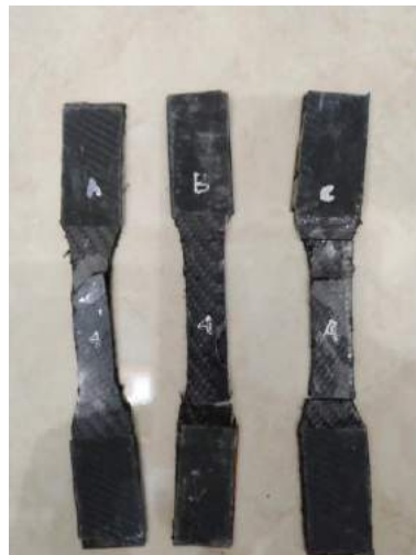
Gambar 4. 24 Hasil Uji 4 Layer Setelah Pengujian Tarik
