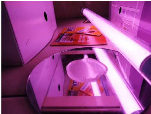
Gambar 4. 3 Proses Curing Dengan Lampu UV Aquarium
