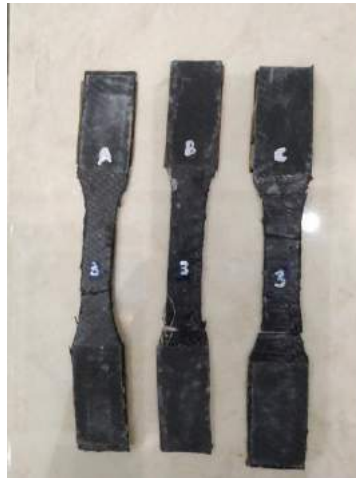
Gambar 4. 23 Hasil Uji 3 Layer Setelah Pengujian Tarik
