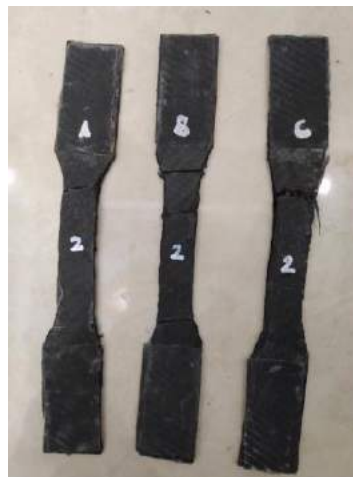
Gambar 4. 22 Hasil Uji 2 Layer Setelah Pengujian Tarik
