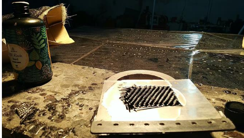
Gambar 3. 5 Gambar Proses Curing Sample Uji Dengan Lampu Tembak Cat Oven
