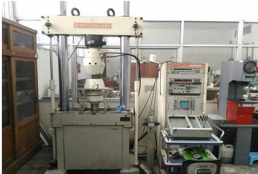
Gambar 3. 23 Alat Uji Tarik di Laboratorium Bahan Fakultas Teknik UGM
