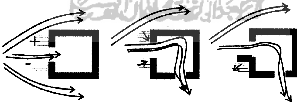
Gb. II.14. Angin masuk ke bangunan dengan cara yang berbeda (sumber : Lipsmeier, G, Bangunan Tropis )
