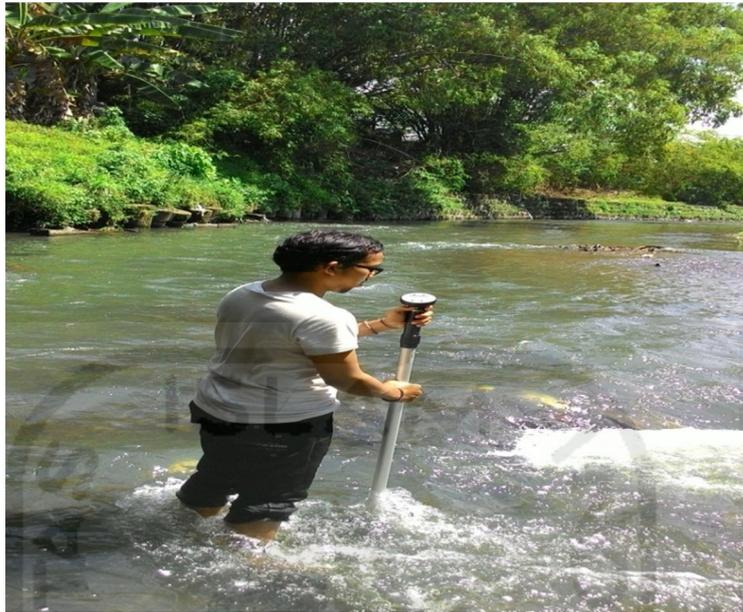
**Gambar 4.7 Pengukuran kecepatan arus menggunakan *Current Meter***
