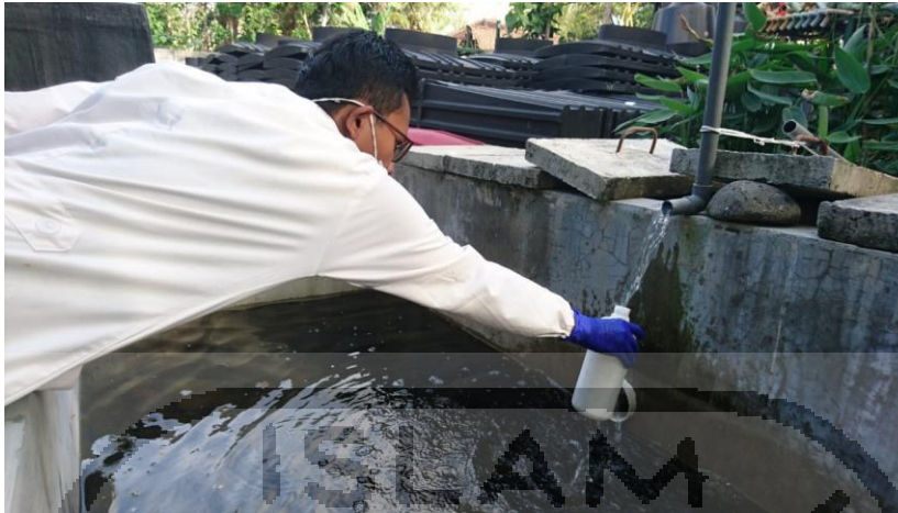
Gambar 4.7 Proses Pengambilan Sampel dengan Metode Grab Sampling pada MBR (Effluen). (Foto: Dokumentasi Pribadi )
