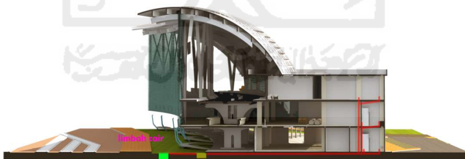
Gambar 5.6 Skema Distribusi Limbah Cair (Sumber : Beny Bali, februari 2016)
