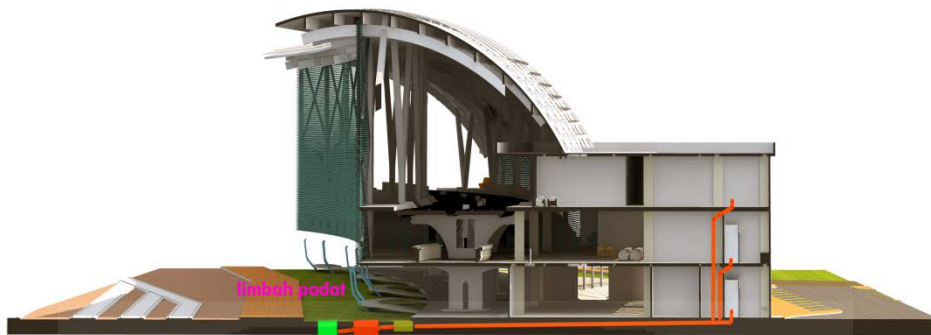
Gambar 5.7 Skema Distribusi Limbah Padat (Sumber : Beny Bali, februari 2016)
