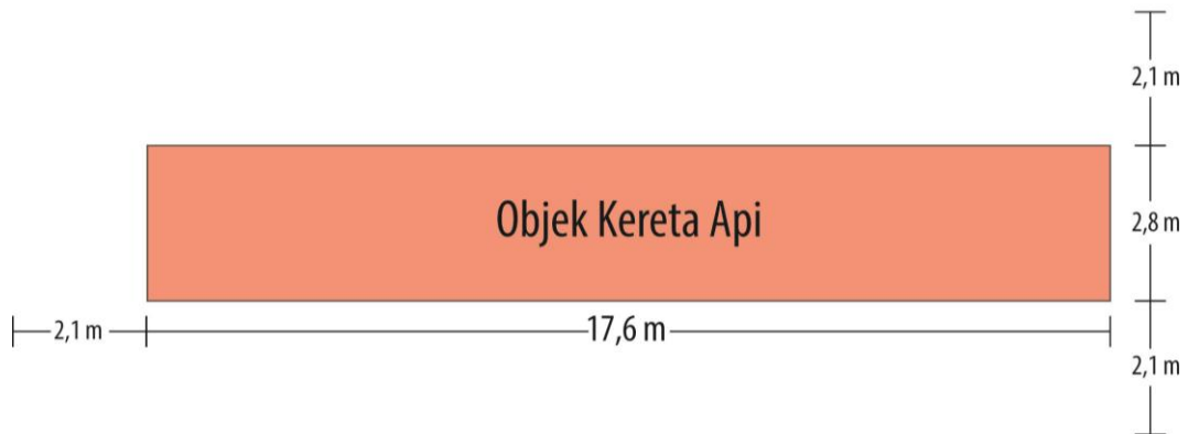
Gambar 3.5 Skema standar batas minimum ruang pameran utama
