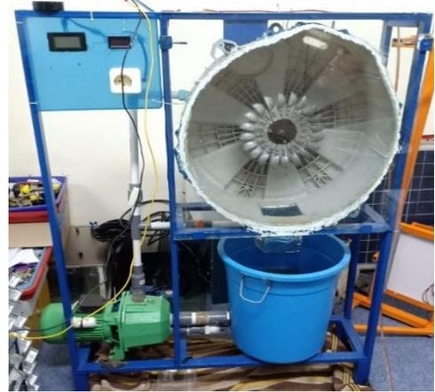
GAMBAR 4.6 PROTOTYPE PLTPH TURBIN TURGO
