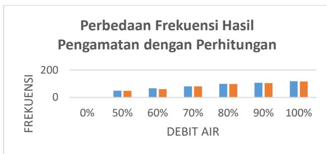
GAMBAR 5.3 DIAGRAM PERBEDAAN FREKUENSI HASIL PENGAMATAN DENGAN PERHITUNGAN
