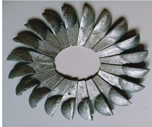
Gambar 3.5 Bentuk Turbin Turgo
