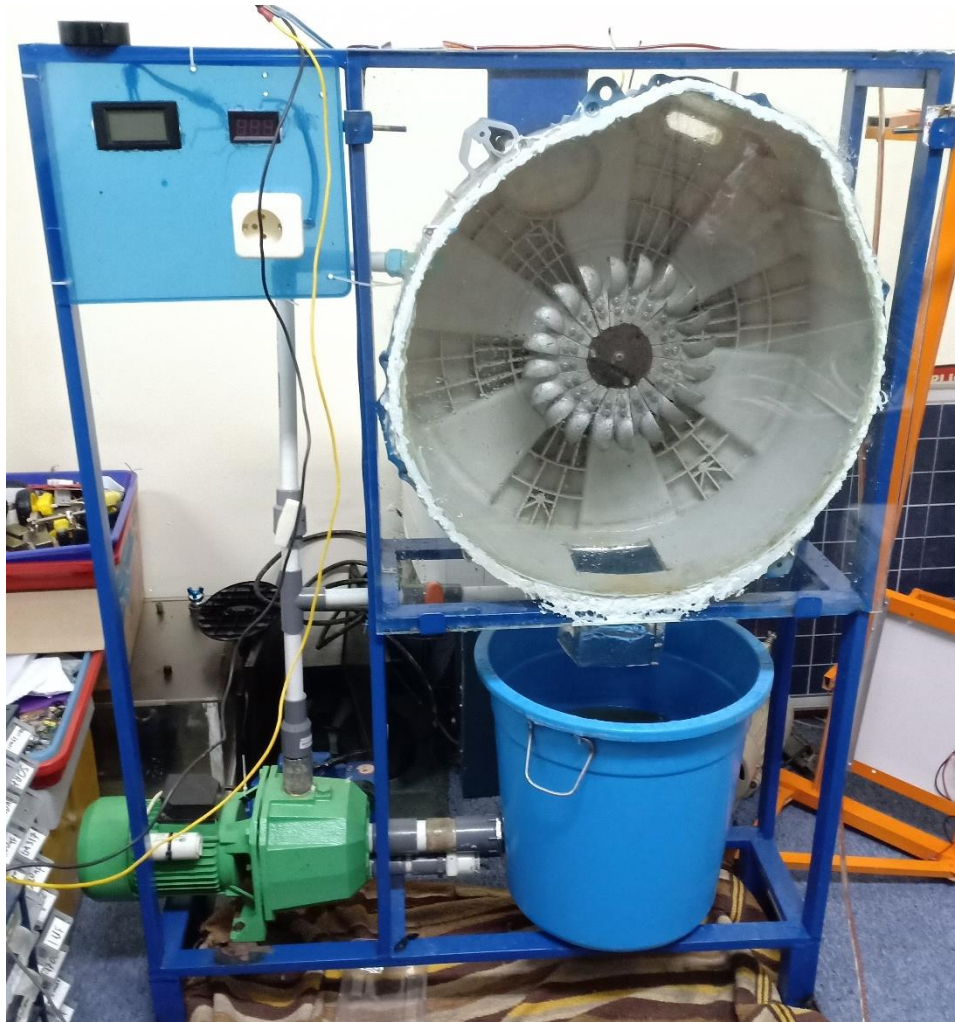
Gambar 3.9 Prototipe PLTPH Turbin Turgo
