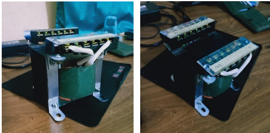
Gambar 3.7 Transformator atau Trafo Step up
