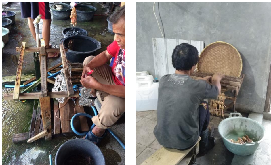
Gambar 4. 5 Proses Pengikatan Logam Dengan Kawat Bekas Pada Industri X dan Y
