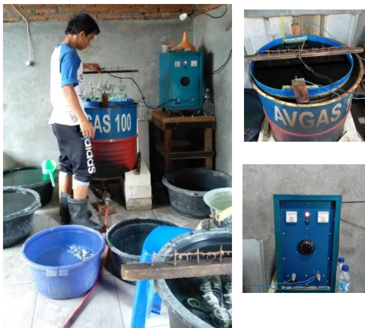
Gambar 4. 7 Proses Pernekel Pada Industri Y
