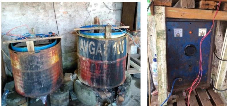
Gambar 4. 6 Proses Pernekel Pada Industri X
