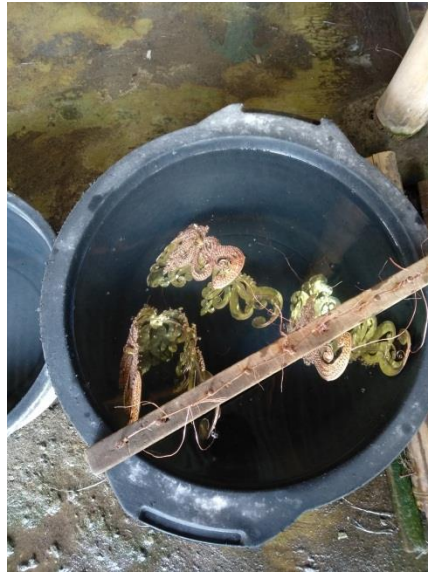
Gambar 4. 14 Proses Pembilasan Emas di Industri X
