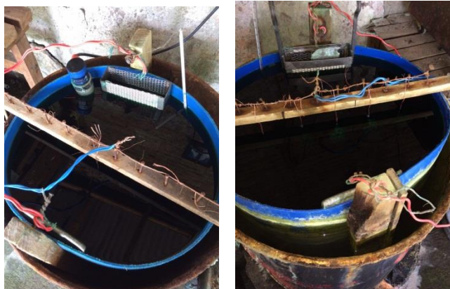
Gambar 4. 15 Proses Pelapisan Warna Rosegold di Industri X
