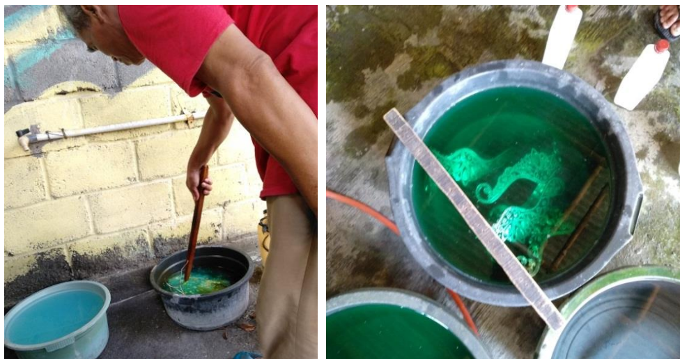
Gambar 4. 3 Proses Pencucian Asam Pada Industri X dan Y
