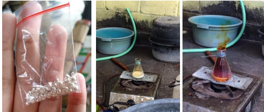
Gambar 4. 9 Biji Perak Murni dan Proses Pembuatan Larutan Perak
