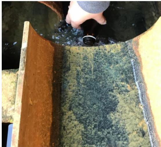
**Gambar 4.2** saluran pengambilan sampel setelah sedimentasi
