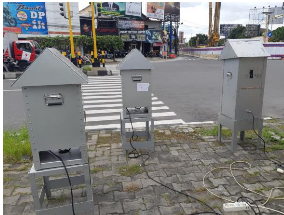
Gambar 4.10. Kondisi saat pengambilan sampel uji udara ambien di Perempatan Kentungan
