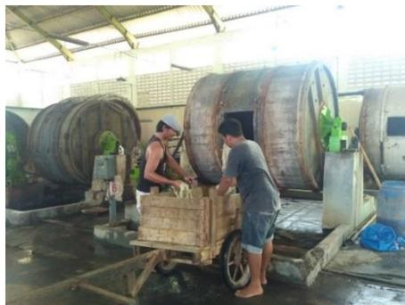
**Gambar 4. 23** *Deliming* dan *Degreasing*
