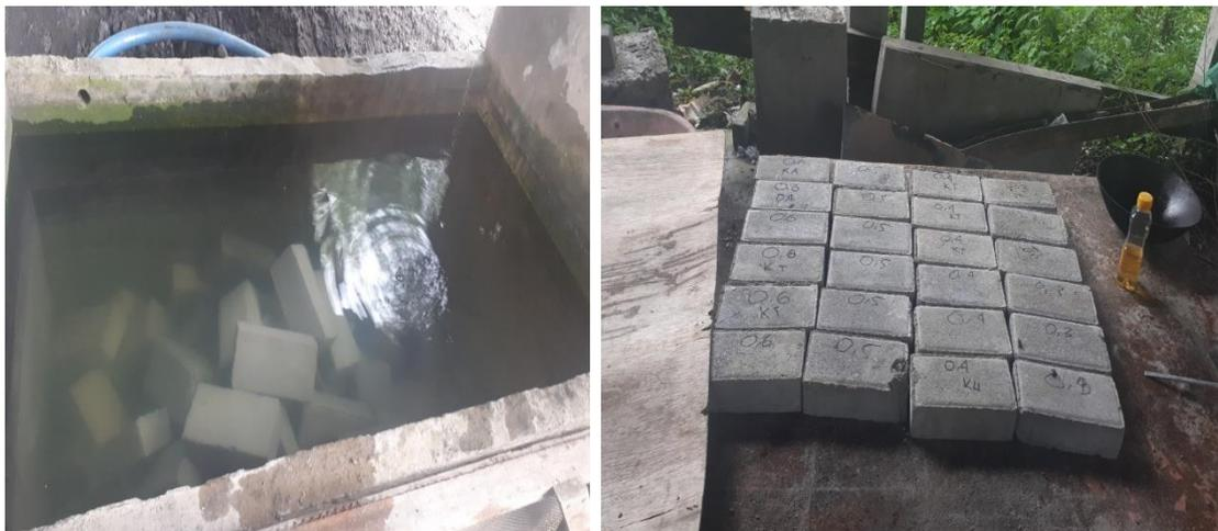
Gambar 4.2 Perawatan benda uji (*Curing*)
