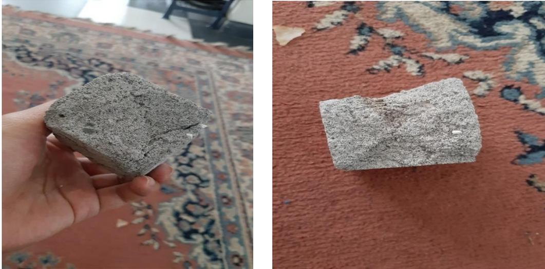
Gambar. 4.2. Pola Retakan pada Benda Uji
