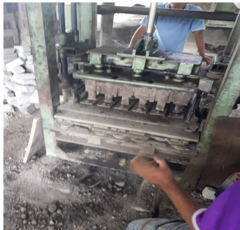
Gambar 3.8. Pencetakan paving block dengan mesin getar
