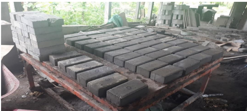
Gambar 3.11. Paving block dikeringkan hingga umur 28 hari
