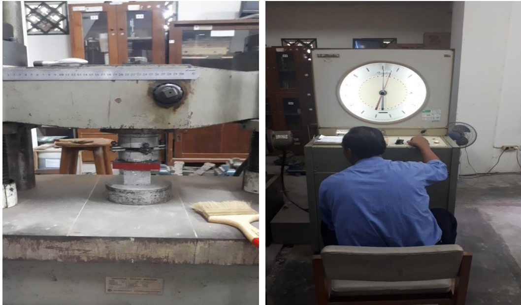
Gambar 3.12. Pengujian Kuat Tekan pada Paving Block
