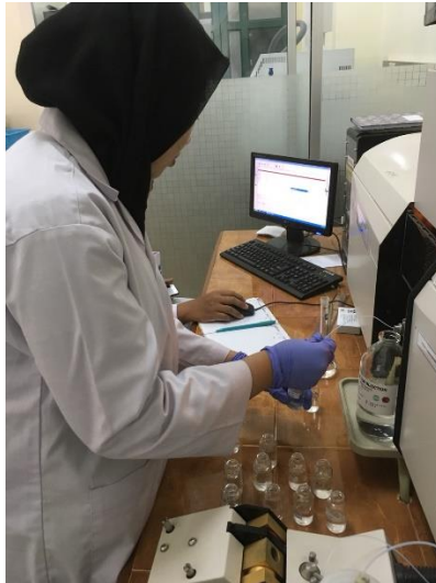
Gambar 3.5 Proses analisis timbal (Pb) menggunakan spektrofotometri serapan atom (SSA) nyala
