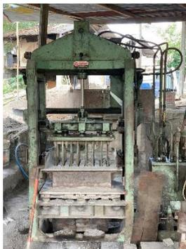
a. Pencetak *paving block*
