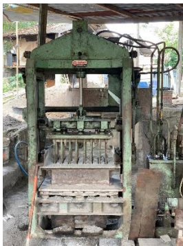
a. Pencetak paving block
