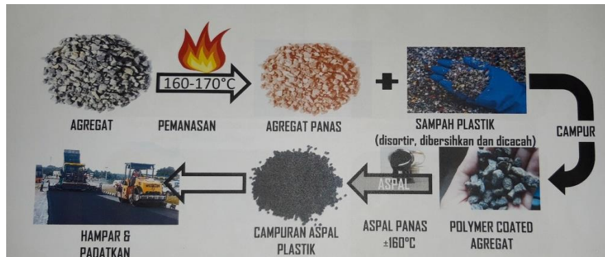
Gambar 3. Proses Pencampuran Sampah Plastik Kresek Sebagai Campuran Aspal
