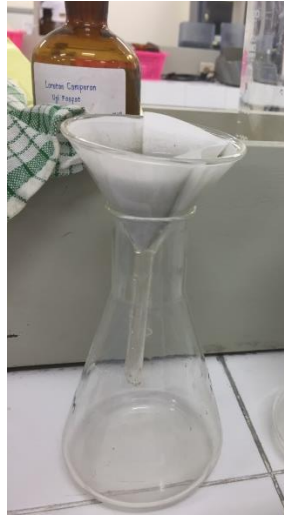
Gambar 9 Pengujian TSS di laboratorium
