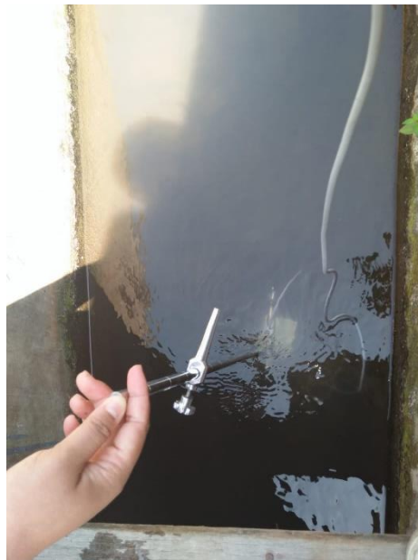
Gambar 10 Pengukuran debit badan air penerima langsung sebelum terjadi pencemaran
