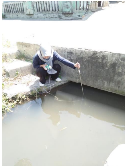
Gambar 11 Pengukuran debit badan air penerima langsung sebelum terjadi pencemaran
