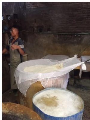
Gambar 4.9. Proses Penggumpalan Industri Tahu X dan Y
