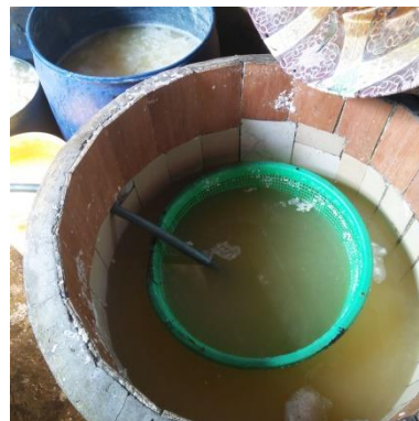
Gambar 4.9. Proses Penggumpalan Industri Tahu X dan Y
