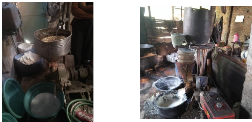
Gambar 4. 3. Proses Penggilingan (A. Tahu X & B. Tahu Y )
