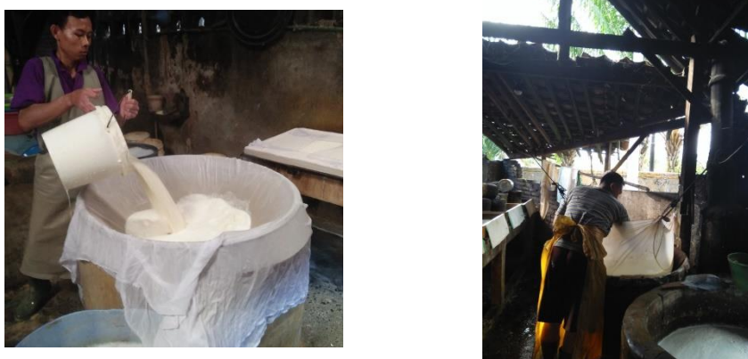
Gambar 4. 5. Proses Filtrasi (A. Tahu X & B. Tahu Y )
