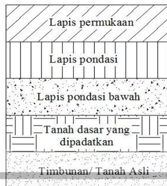
**Gambar 3.2 Struktur Perkerasan Lentur**
