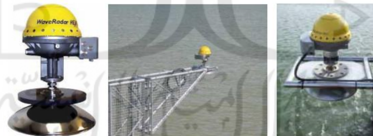
Gambar 2.5 Bentuk dan penempatan radar tsunami.
