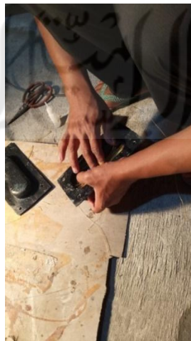
Gambar 3.12 Pelapisan Wax dan PVA pada cetakan
