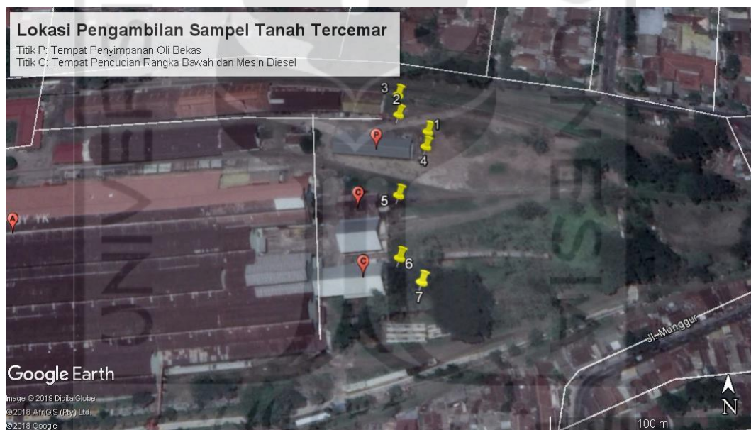
Gambar 3. 2. Titik sampel pengambilan tanah tercemar yang dilakukan di dekat sumber pencemar di PT. X, Yogyakarta (titik warna merah: sumber pencemar, titik warna kuning: pengambilan sampel tanah)
