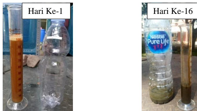
Gambar 4. 6 Perbedaan warna kompos cair reaktor 1 (2 kg sisa makanan : 6 kg sayur) pada hari ke-1 dan ke-16
