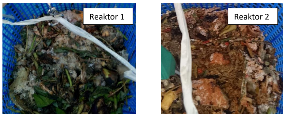
Gambar 4. 3 Kondisi kompos reaktor satu pada pH 5,6 dan reaktor dua pada pH 5,5 dengan metode reaktor aerob termodifikasi
