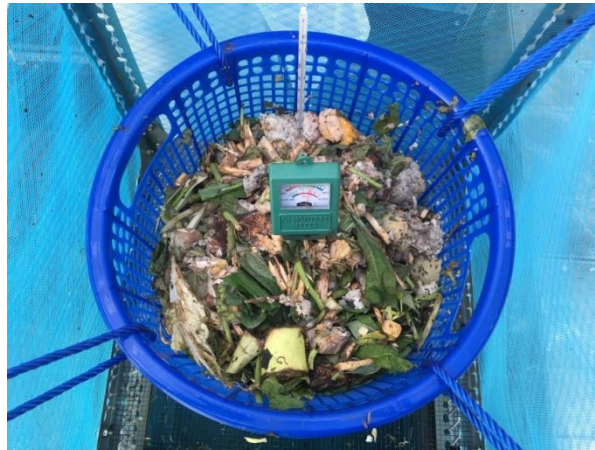
Gambar 3. 6 Pengujian parameter suhu dan pH pada reaktor setiap hari selama proses pengomposan
