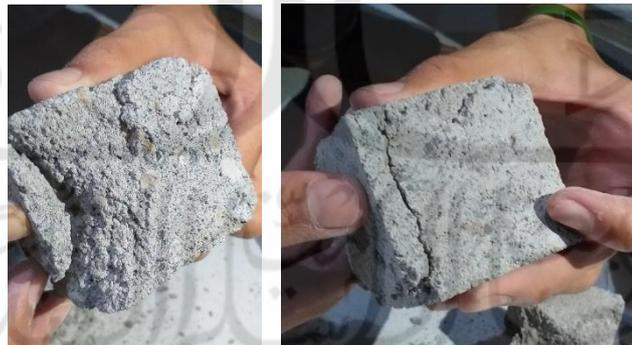
**Gambar 3. 1 Pola Retakan pada Sampel Uji**
