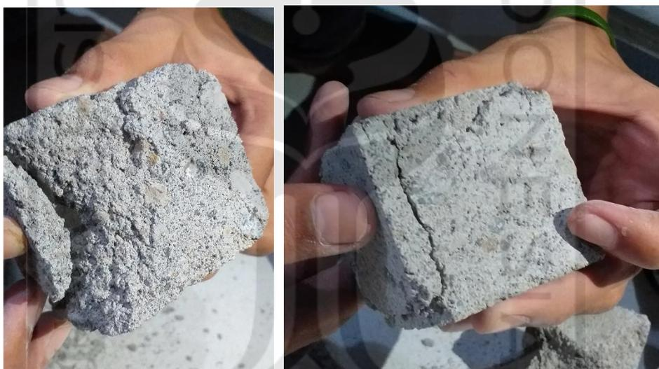
**Gambar 4. 2 Pola Retakan pada Sampel Uji**
