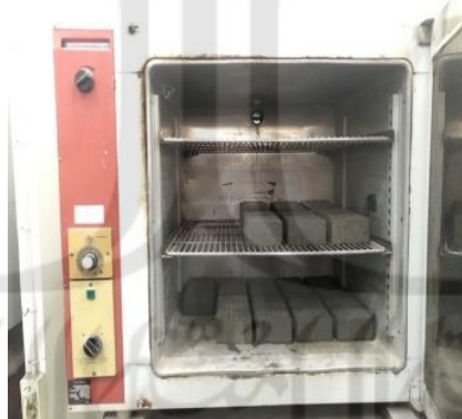
Gambar 3. 11 Proses Pengeringan Paving Block Di Dalam Oven
