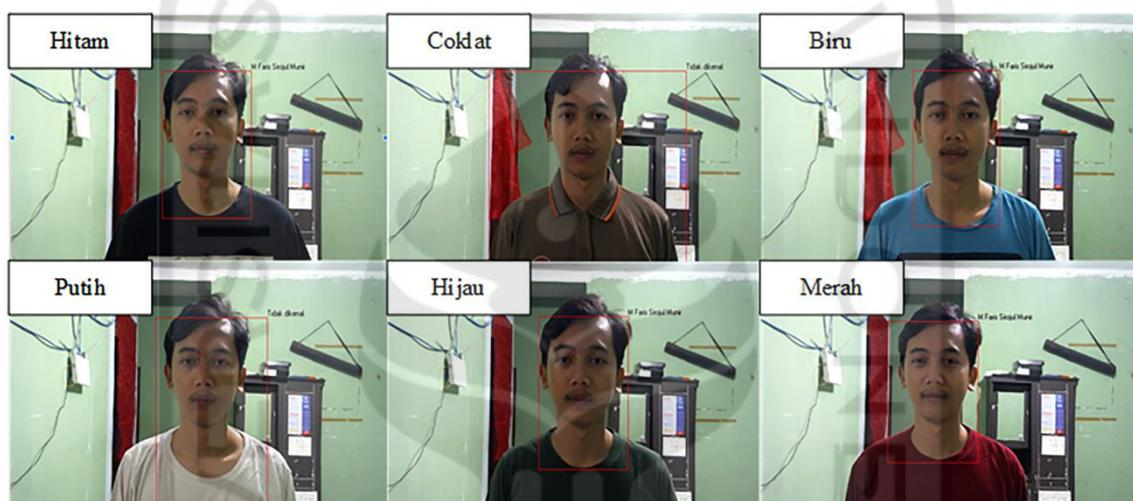
Gambar 4.2 Pengujian *face detection system* dengan variasi warna baju objek
