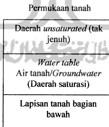
Gambar 2.1. Penampang melintang tanah dan posisi air tanah ( groundwater ) didalam tanah (modifikasi Miller, 1992 dalam Hefni, 2003)
