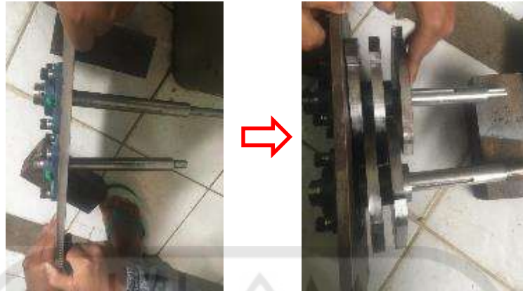
Gambar 4-2 Proses pemasangan mata pisau.
