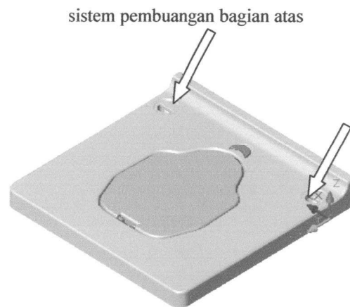
Gambar 3.11. Desain sistem pembuangan air tampak atas
