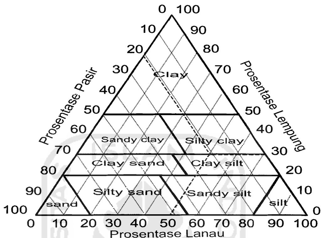
Gambar 6.3 Diagram klasifikasi Tekstur segitiga USCS Lumpur Lapindo
