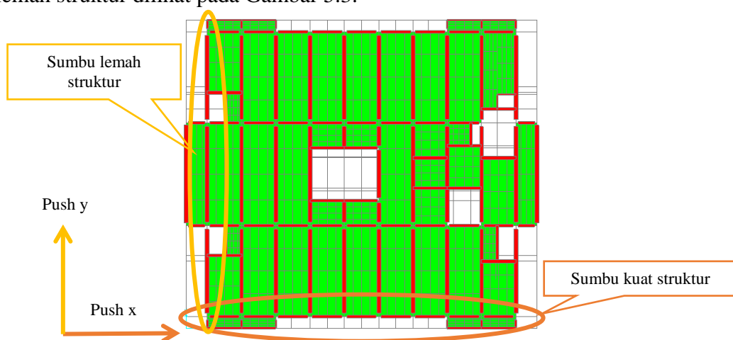
Gambar 5.39 Sumbu Kuat dan Sumbu Lemah Struktur
