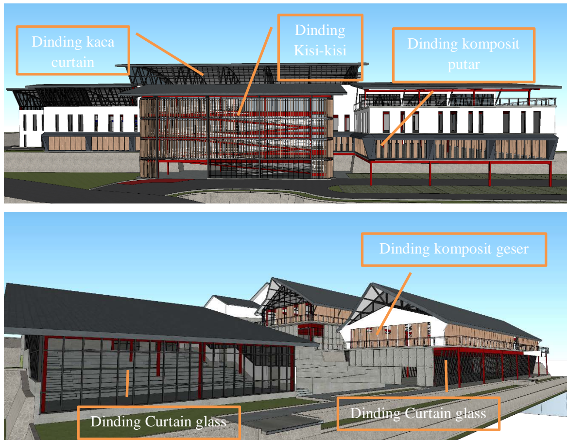
Gambar 54 (atas), dinding kisi-kisi komposit dan dinding putar komposit pada bangunan. (bawah) dinding kaca curtain serta dinding geser komposit pada bangunan. Analisis penulis, 2018.
