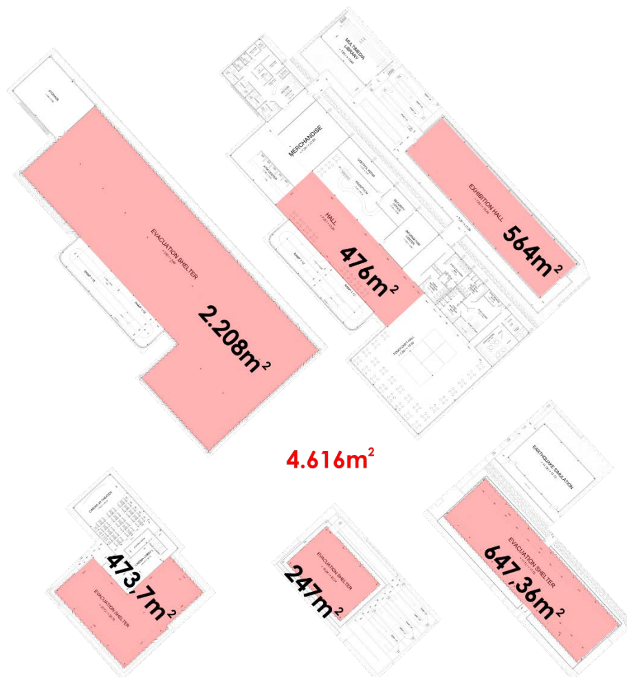
Gambar 48. Ruang- ruang yang digunakan sebagai shelter evakuasi. Penulis 2018.
