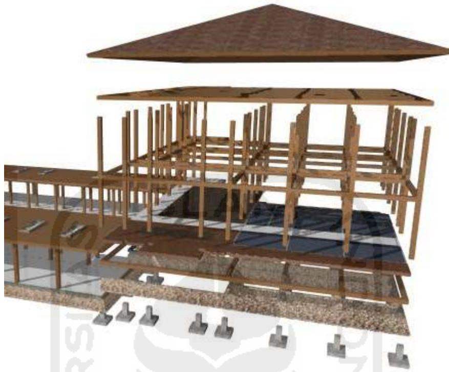
Gambar 5.34 Sistem struktur bangunan (Sumber: Analisis Penulis, 2015)
