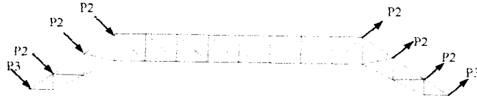
Gambar. 4.21 Perencanaan beban angin kuda-kuda K3
